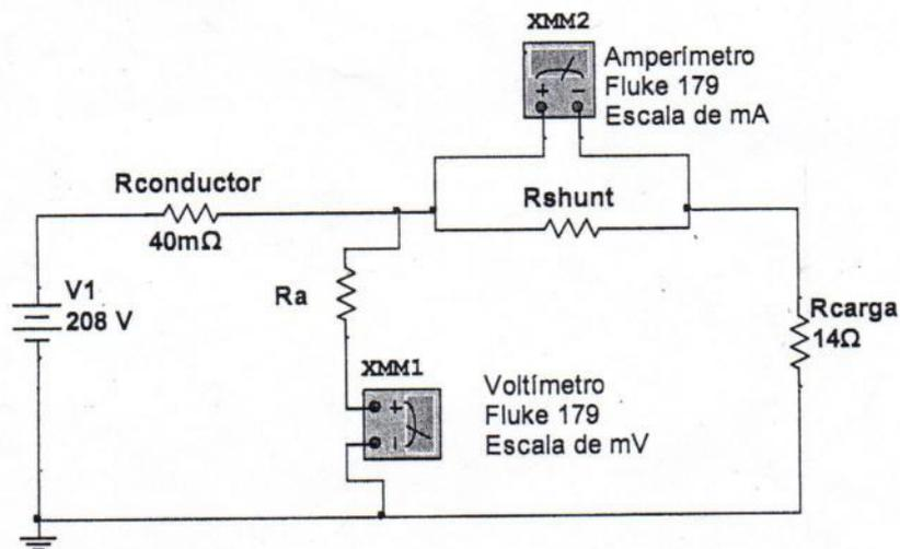
1. Diseñe el sistema de medición de corriente, si el equipo disponible para esta tarea es el especificado en el montaje (15 puntos).
